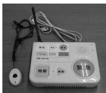
緊急通報システム
