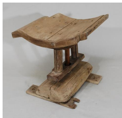
回転台に載せた棧瓦の成形台
